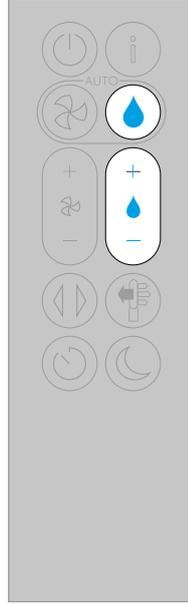
Wenn Sie für Ihren Dyson Luftreiniger mit Befeuchtungsfunktion den Auto-Befeuchtungsmodus festlegen, passen die integrierten Sensoren die Geräteeinstellungen intelligent an die Temperatur und die Feuchtigkeit im Raum an.
