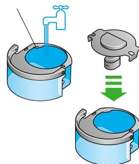
Füllen Sie den Wassertank wieder bis zur Max-Markierung auf, wischen Sie überschüssiges Wasser ab und setzen Sie die Kappe wieder auf. Stellen Sie dabei sicher, dass die Clips an der Kappe eingerastet sind.
