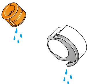
Entfernen Sie die Kappe, nehmen Sie den Verdunster aus dem Wassertank heraus und spülen Sie ihn unter kaltem Wasser aus.
