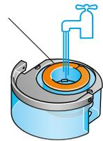
Stellen Sie den Verdunster in den Wassertank. Füllen Sie den Wassertank bis zur MAX-Markierung mit kaltem Leitungswasser.
