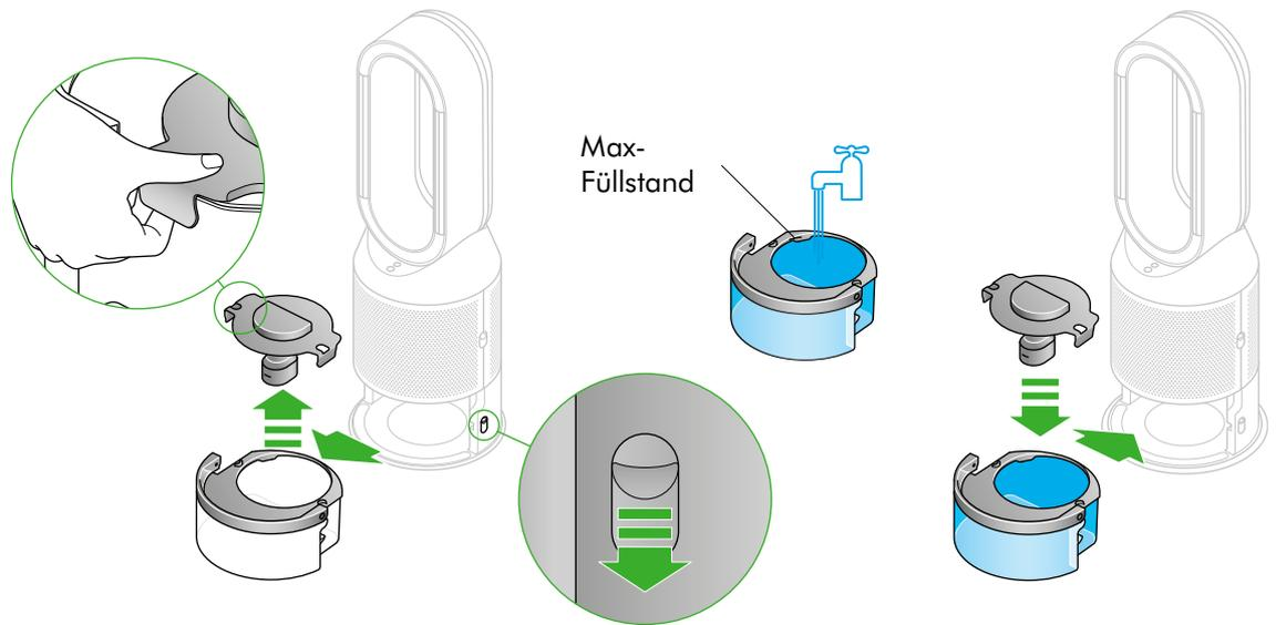
Stellen Sie vor dem Entnehmen des Wassertanks sicher, dass kein Befeuchtungsmodus aktiviert ist.
