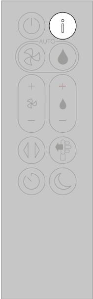
Drücken Sie auf diese Taste, um durch die verschiedenen Parameter zu scrollen, die Ihr Dyson Luftreiniger mit Befeuchtungsfunktion überwacht.
