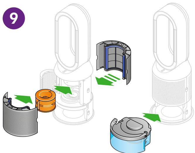
Schieben Sie den Verdunster zurück in das Gerät und stellen Sie dabei sicher, dass er sich fest in seiner Position befindet.
