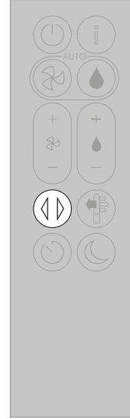
Drücken Sie auf die Taste für die Drehbewegung und wählen Sie zwischen einer Drehbewegung von 0°, 45° und 90° oder dem Brise-Modus aus.
