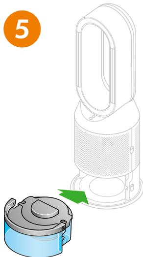
Schieben Sie den Wassertank in das Gerät, bis er fest einrastet.
