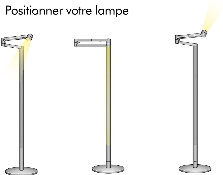
Vous pouvez facilement changer la position de l'éclairage en faisant pivoter la tête optique, le bras et la tige séparément jusqu'à 360°.
